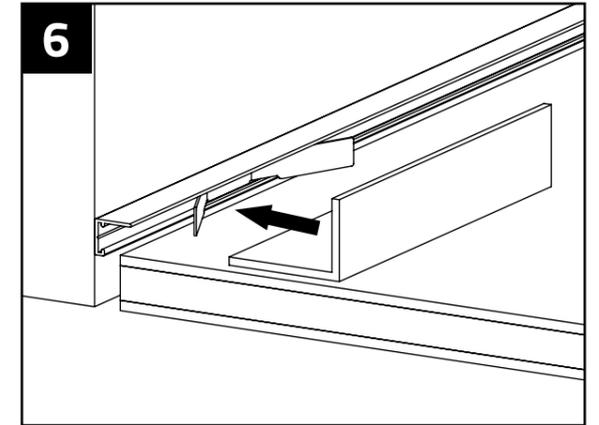
Die Abschlussleiste mit den eingeschobenen Montageclips wird nun an der Wandfläche in Montageposition gebracht. Mit der Montagehilfe werden die Montageclips vorsichtig aufgespreizt, indem mit der Montagehilfe die Montageclips Richtung Wand beaufschlagt werden.
