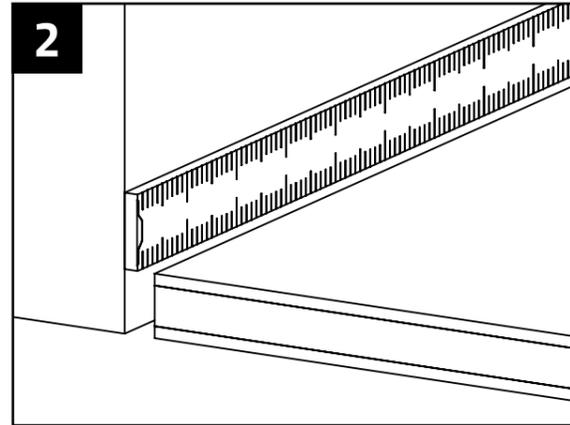
Die Abmessungen für die Profilschnitte werden an den Wandflächen abgenommen. Gehrungsschnitte für Innen- und Außenecken werden hierbei berücksichtigt.
