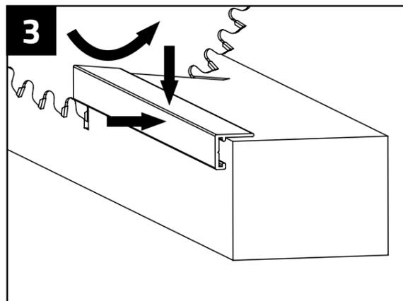
Die Profile werden passend abgelängt. Hierbei wird in einem Arbeitsgang der Gehrungsschnitt für Innen- oder Außenecke angebracht. Das Profil wird dabei sicher auf einen Holzträger gedrückt und in der Säge schnittgerecht positioniert. Die Schnittrichtung der Säge drückt dabei das Profil beim Schneidevorgang an den Holzträger.
