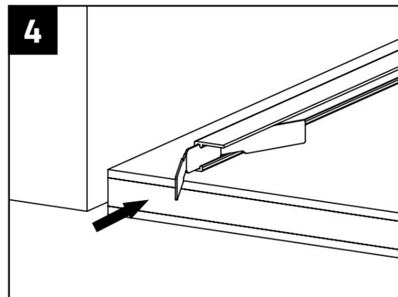
Die Montageclips werden stirnseitig in die Abschlussleiste eingeschoben. Achtung: In der Abschlussleiste sind zwei gegenüberliegende Absätze eingearbeitet, zwischen denen die Montageclips leichtgängig geführt werden.
