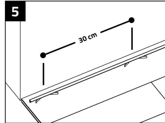
Die Montageclips sollten in einem Abstand von etwa 30 bis 60 cm zueinander in die Abschlussleiste eingeschoben werden. Je nach Unebenheiten im Mauerwerk können einzelne Montageclips in engeren Abständen installiert werden, damit die Abschlussleiste flächenbündig am Mauerwerk anliegt.
