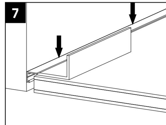
Sobald der Spannvorgang abgeschlossen ist, wird die Abschlussleiste nach unten gedrückt und die Montagehilfe abgezogen. Nun wiederholt sich der Spann- und Montagevorgang, bis alle Montageclips einer Abschlussleiste gespannt und versenkt sind. Zu evtl. Korrekturen kann die Abschlussleiste jederzeit aus der Anschlussfuge entnommen werden.
